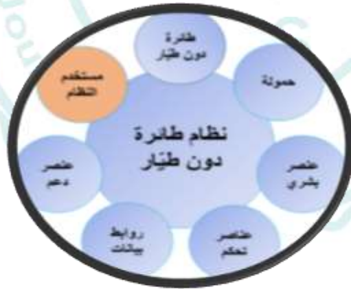
شكل (١) عناصر أنظمة التشغيل للطائرات دون طيار
