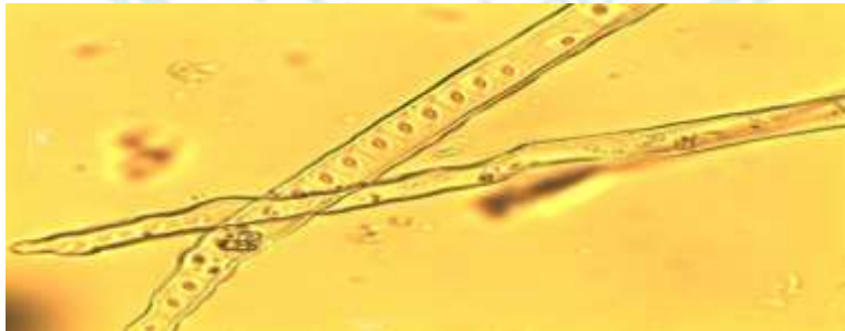
الشكل (٧) جدر ملساء Smooth في قصيبات ساق خشب النوع السرو العطري Cupressus macrocarpa (قوة تكبير ١٠ x).
